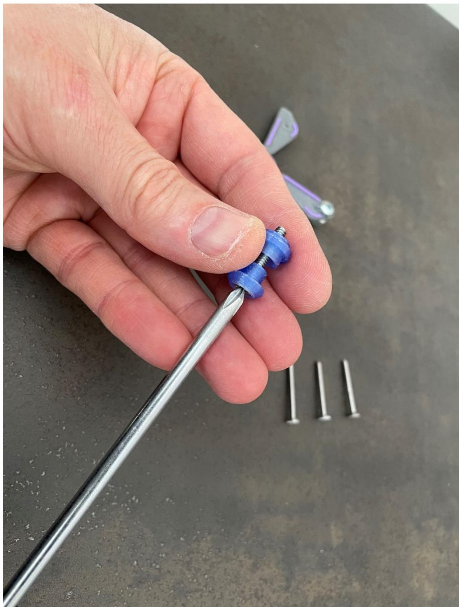
Etape 4 : Insérez l'hélice entre les deux éléments du support démonté.
